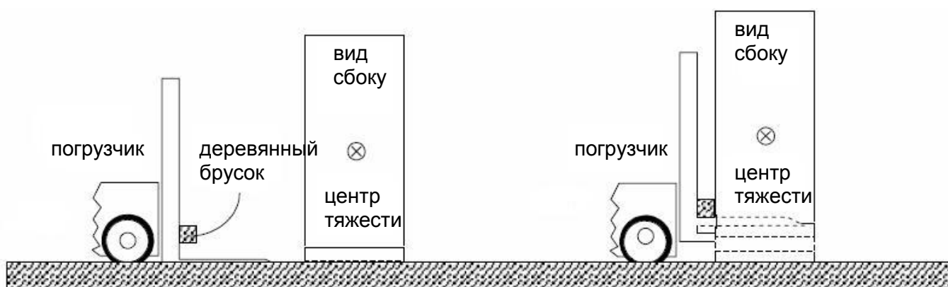
Рис. 6-10 Перемещение шкафа вилочным погрузчиком
