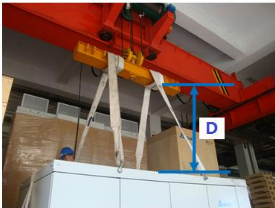
Рис. 6-11 Способ 1 перемещения краном
