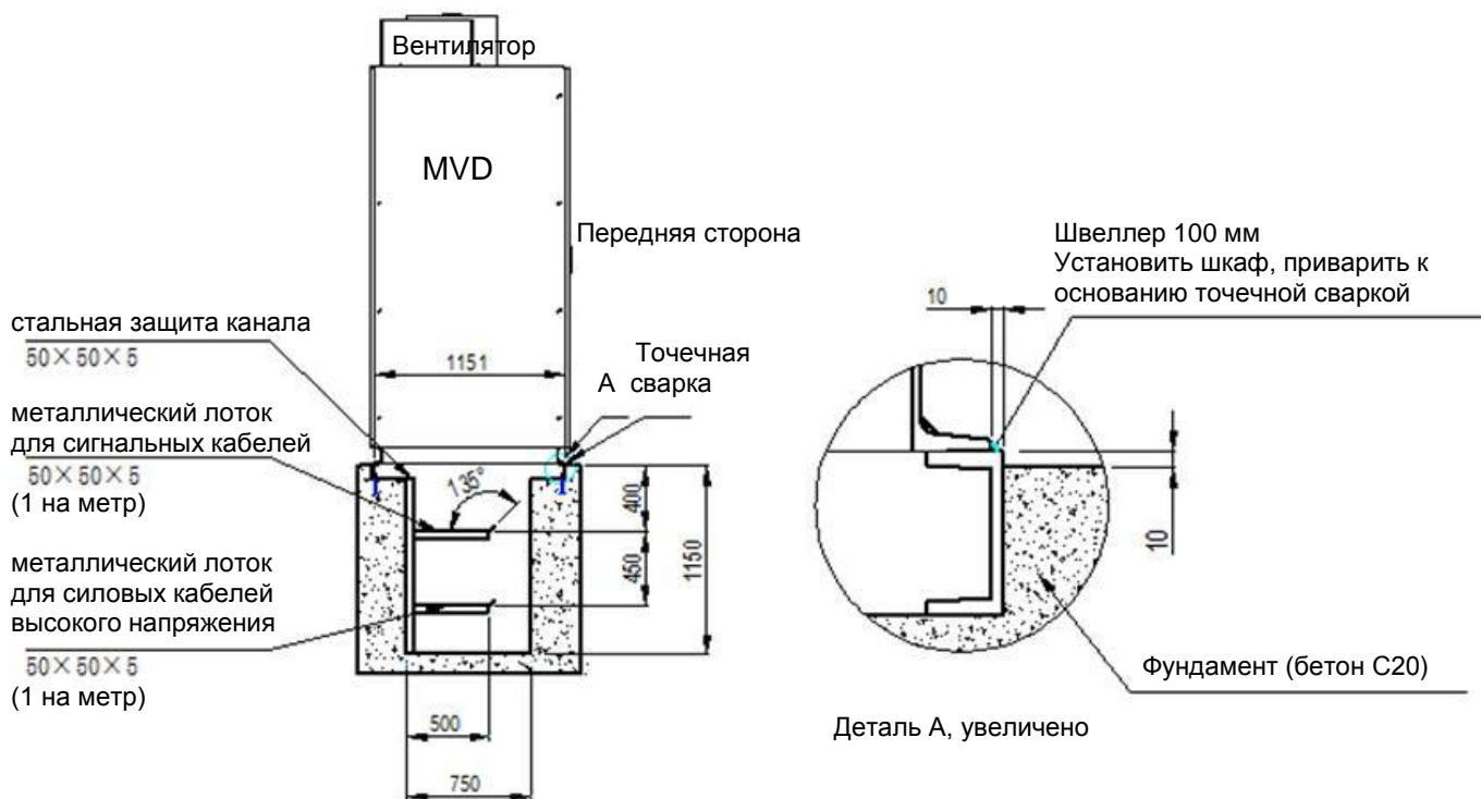
Рис. 6-13 Кабельный канал в разрезе
